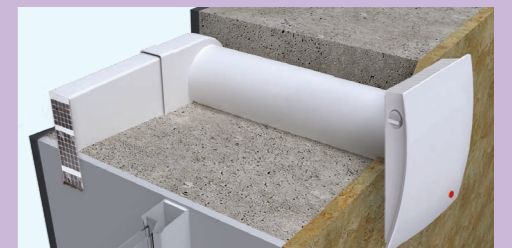
Кутвий монтаж із застосуванням набору НП 160 білого
